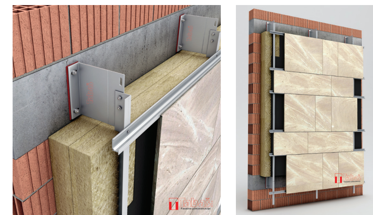
Sistem TABAS N23 može odgovoriti na sve češći zahtev od 20cm debljine termo izolacije, gde fasada može izaći i 325mm od konstrukcije objekta
